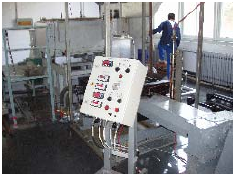
Линия непрерывного литья хлористомедной ленты
