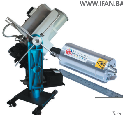
Многоволновый рамановский лидар Multiwave Raman Lidar
