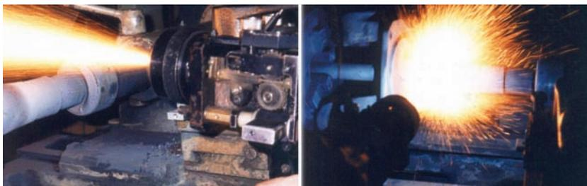
**Рис. 30 – Процесс нанесения покрытия на изношенную поверхность поворотного кулака троллейбуса ЗиУ-682 В1**
