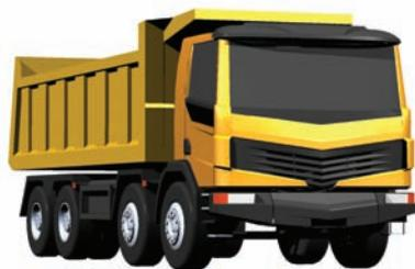
**Рис. 10 – Внешний вид тягача дорожного автопоезда МЗКТ грузоподъемностью до 50 т: а – опытный образец; б – вариант дизайнерского решения**
