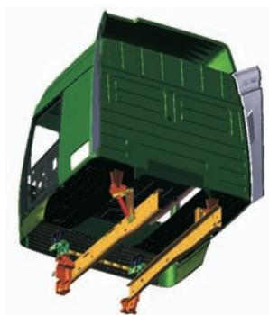
**Рис. 7 – Общий вид автопоезда (а) и сборки модели системы поддресоривания кабины (б)**
