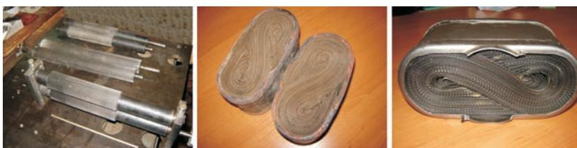
**Рис. 25 – Разработка подложки каталитического блока из металлической фольги**
