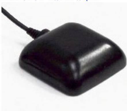
Предназначены для систем спутниковой навигации (ГЛОНАС, GPS). Используются керамические материалы с относительной диэлектрической проницаемостью 40, 21 и 6. Изготовлены экспериментальные образцы
