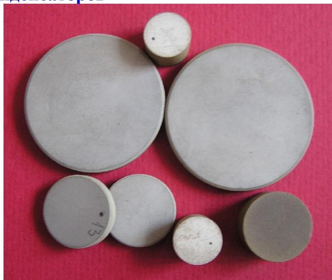
Керамический материал предназначен для производства энергоемких конденсаторов, предназначенных для изготовления накопителей электрической энергии. Обеспечивает удельную энергоемкость до  $0,7 \text{ Дж/см}^3$ .
