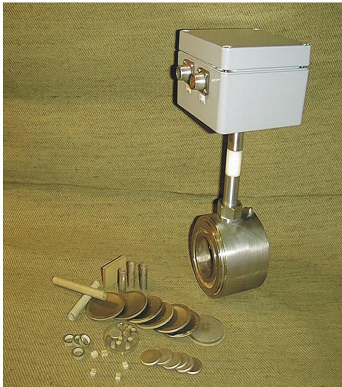
Предназначен для эксплуатации в составе комплекта теплосчетчика (расходомера) или для использования в других устройствах: диапазон рабочих температур измеряемой жидкости (5...130)С; типоразмеры трубопровода: 25; 50 мм; конструктивное устройство: Корпус (70x70) мм; Каркас (материал сталь 12Х18Н10Т); Приемо-излучатели (2 шт.).
