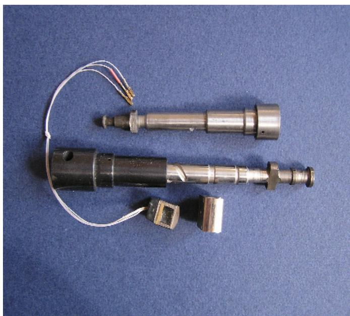
Технология нанесения тонкослойных (микронных) упрочняющих (на основе аморфных сплавов  $H_v > 800$ ) и самосмазывающих покрытий (на основе сплавов меди) для прецизионных деталей, работающих в режимах интенсивного абразивного износа. Испытания опытных образцов проводились в НПО «Триботехнологии».
