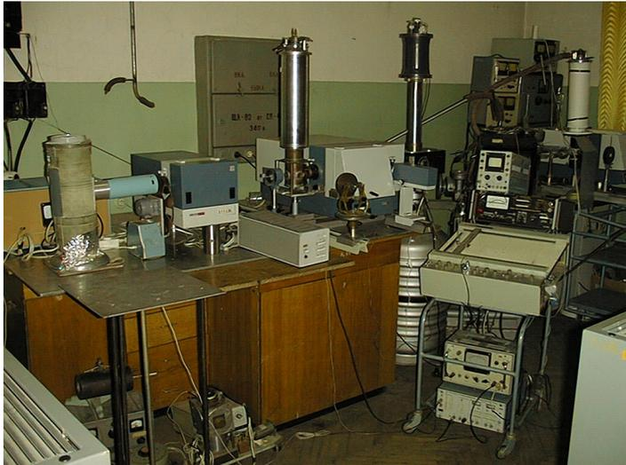
Высокочувствительный измерительный спектральный комплекс для контроля малых концентраций ( $10^{-6}$  ат.%) примесно-дефектных комплексов в алмазах позволяет проводить классификацию искусственных алмазов, определять область и диапазон их практического применения.
