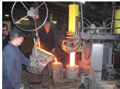
ную массу извлеченной заготовки. Таким образом, затвердевание металла в кристаллизаторе происходит непрерывно в течение всего времени разливки, а заготовки извлекают через определенный период, т.е. процесс осуществляют в непрерывно-циклическом режиме.
